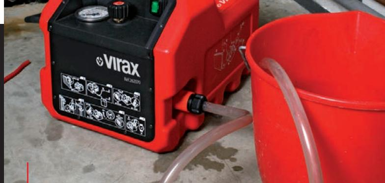
Будьте в автономном состоянии: всасывайте из внешнего резервуара, если нет поступления воды.
