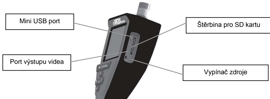
Obrázek 7 – Vstupy a výstupy zařízení mini VISIOVAL
