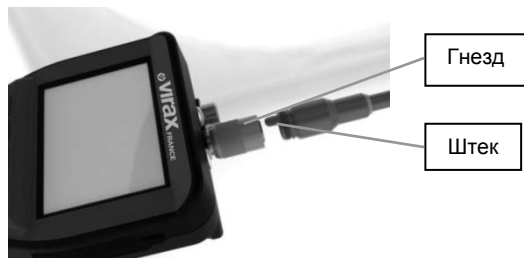
Рисунок 5 – Кабельное подключение (черный 9-штыревой коннектор типа А)
