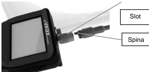
Figura 5 – Connessione cavo (Connettore tipo A, 9 perni, nero)
