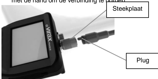
Figuur 5 -Kabelverbinding (type A-connector, 9 pinnen, zwart)
