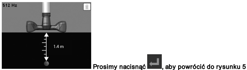
Rysunek 6 – Funkcja głębokościowego wykrywania LOKALIZATORA (Nr ref. 294130)
