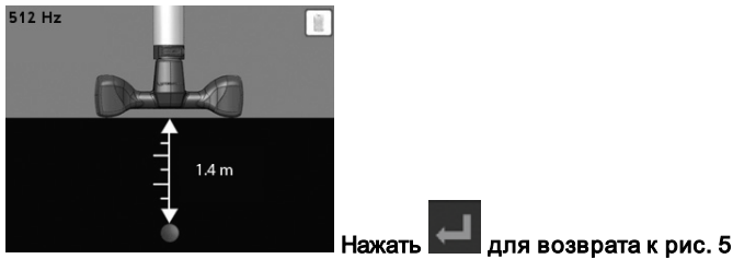
Рисунок 6 – Определение глубины ЛОКАТОРОМ (арт. 294130)
