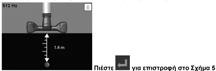
Σχήμα 6 – Ανίχνευση βάθους του ΕΝΤΟΠΙΣΤΗ (Αναφ. 294130)
