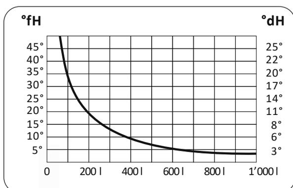
Capacité maximale de filtration d'eau par la cartouche en fonction de la dureté de l'eau : voir graphique. Exemple pour une eau à 10°fH / 6°dH : 400 litres.
